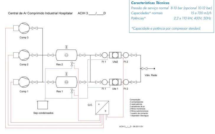
Diagrama típico da ACIH com 3 compressores + 2 reservatórios + 2 unidades de tratamento. Outras configurações disponíveis. Ex.: 3 compressores. + 3 reservatórios. + 3 unids. tratamento
