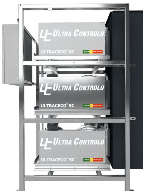
Todos os racks permitem que os compressores passem do modo automático (alternando entre os compressores para garantir o desgaste uniforme) ou do modo manual quando um compressor é removido para manutenção preventiva. Cada compressor está equipado com o seu próprio pressostato de arranque e paragem automáticos de acordo com a pressão predefinida para que estes modos estejam disponíveis e para garantir o abastecimento contínuo da rede na pressão de regulação predefinida.
